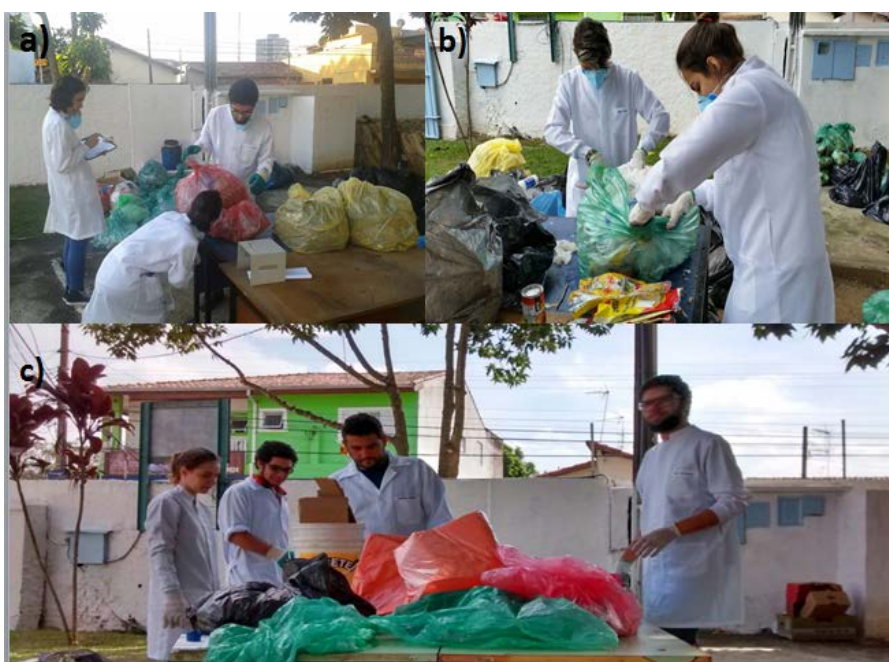
Figura 1- a) Composição gravimétrica de resíduos por agrupamento; b) Triagem e separação por classe dos resíduos; c) Aferição da densidade dos resíduos. Fonte: Banco de dados do Projeto OSCL
